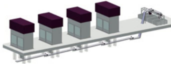
zentrale Schrottentsorgungssysteme mit permanent magnetischen Rutschförderern
