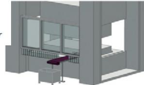
Beispiel: Schrottentsorgung aus dem Werkzeug mit p.m. Gurtbandförderer
