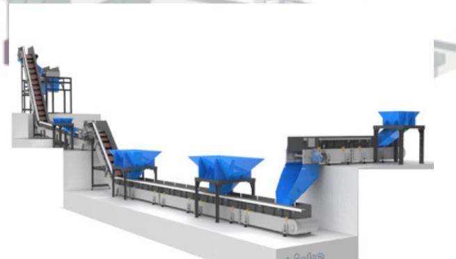
zentrale Schrottentsorgungssysteme mit Scharnierbandförderern
